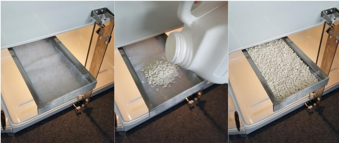
Die Atemkalk-Schublade sollte ungefähr bis zu einer Höhe von 1,5 bis 2 cm mit Atemkalk befüllt werden.
